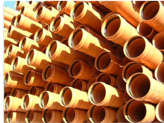
Tubería PVC serie 16.5 material mas comúnmente utilizado en redes, periodo de retorno de diseño 10 años
