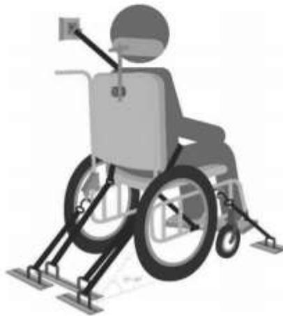
Figura 2. Ángulo de colocación del cinturón pélvico del vehículo
