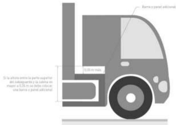
Para minimizar la corrosión y aumentar su vida útil del dispositivo, éste debe estar hecho de acero inoxidable
